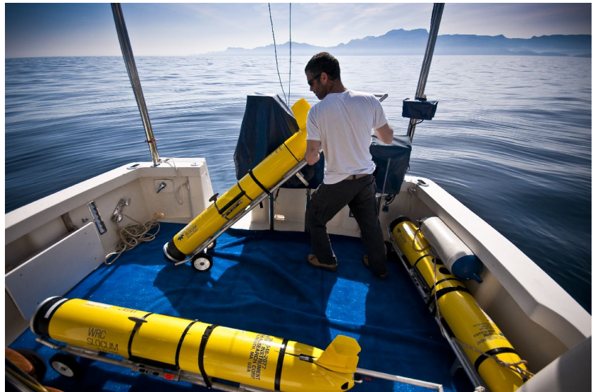
Tècnic de l'IMEDEA (CSIC-UIB) realitzant el llançament del planador a l'aigua durant una missió oceanogràfica a la mar Balear. Foto: E. Vidal.
